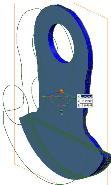
Figura 3.20 – Extração de seções do STL gerado do resultado da otimização.
