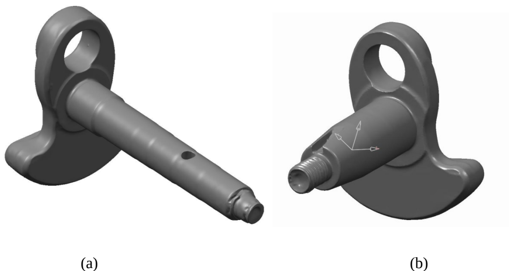
Figura 1.5 – Modelos digitalizados dos contrapesos do virabrequim original: lado da espiga (a) e lado do volante (b).
